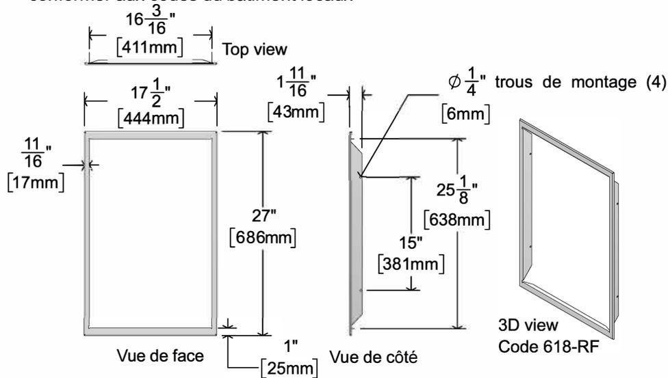
1.) utiliser des vis pour fixer le cadre au mur
